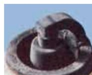
Bujía fría instalada en motor que exige bujía caliente: fallas de encendido.
