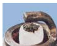
Bujía caliente instalada en motor que exige bujía fría: auto-encendido.
